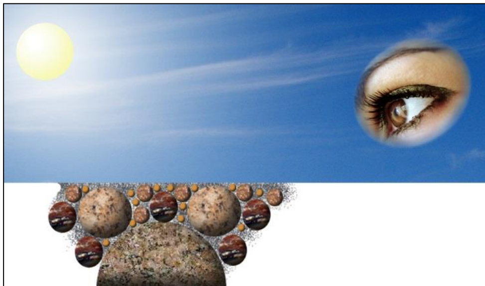
Figuur 5.2 De kleur van het beton wordt bepaald door de kleur van de zichtbare kleine korrels aan het betonoppervlak.
