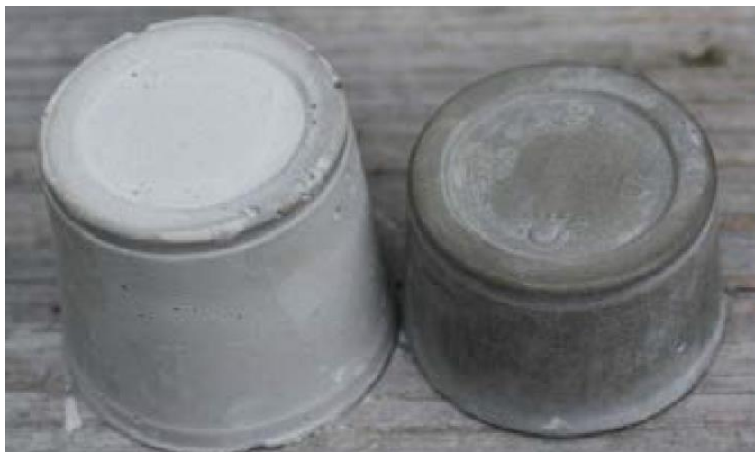
Figuur 5.13 Invloed van de water-cementfactor op de kleur van beton; links: wcf = 0,6 , rechts: wcf = 0,3 . Basissamenstelling: 100 g CEM III/B en water.
